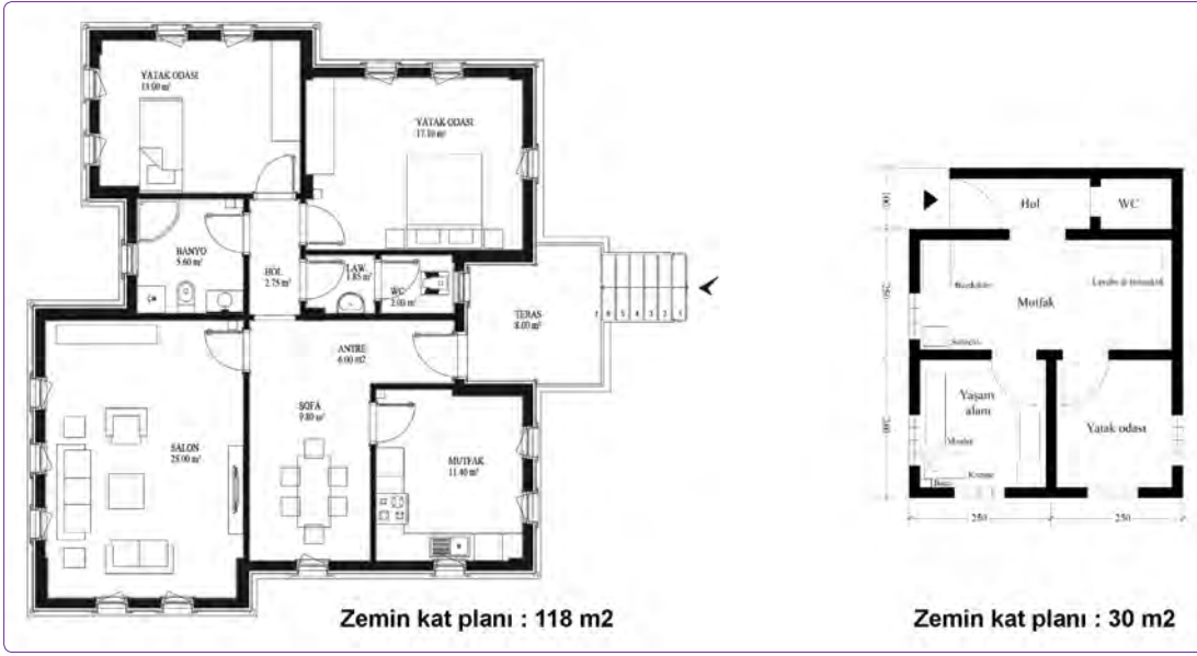
Şekil 6. Balıkesir yöresi için tasarlanmış kırsal konut tip projelerinden birine ait zemin kat planı (solda) (Kaynak: Yöresel Mimari Özelliklere Uygun Konut Projeleri 1, 2017) 41 ve Karyagmaz köyünde incelenen bir konuta ait zemin kat planı (sağda).
