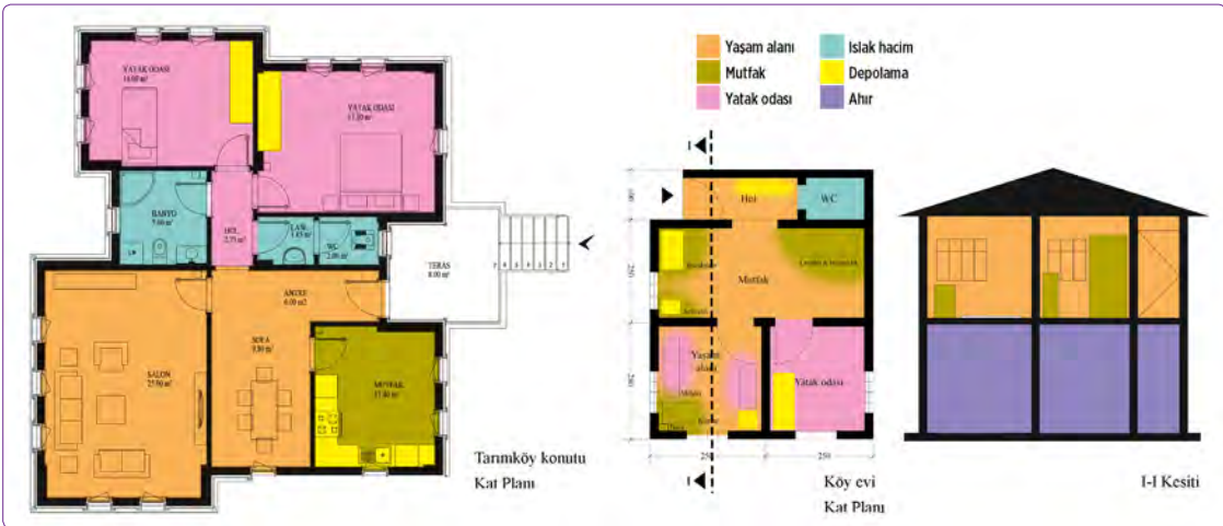
Şekil 10. Balıkesir yöresi için tasarlanmış kırsal konut tip projelerinden örnek (solda) (Yöresel Mimari Özelliklere Uygun Konut Projeleri 1, 2017) ve Karyağmaz Köyü'nde incelenen konuta ait kat planı ve kesit kullanım analizi (sağda).
